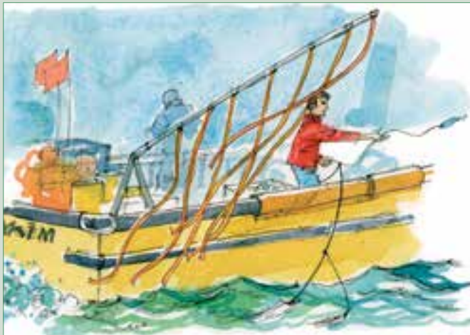
图1 将带有诱饵的钩钩靠近船体向船首方向抛投以保证钩钩在通过船尾之前开始下沉
