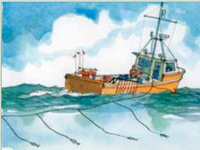
图2 舷侧投绳和彩色飘带组合使用
