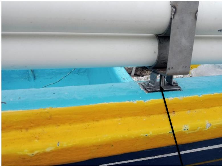
Las platinas van colocadas en la embarcación con pernos adjuntos.
