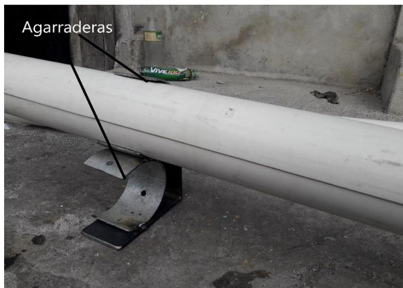
**Agarraderas o sujetadores de los tubos:** estos sujetadores están hechos de tubo galvanizado de 3 pulgadas, van soldadas y colocadas una encima del otro a una platina de  $\frac{1}{2}$  x  $\frac{3}{16}$ .
