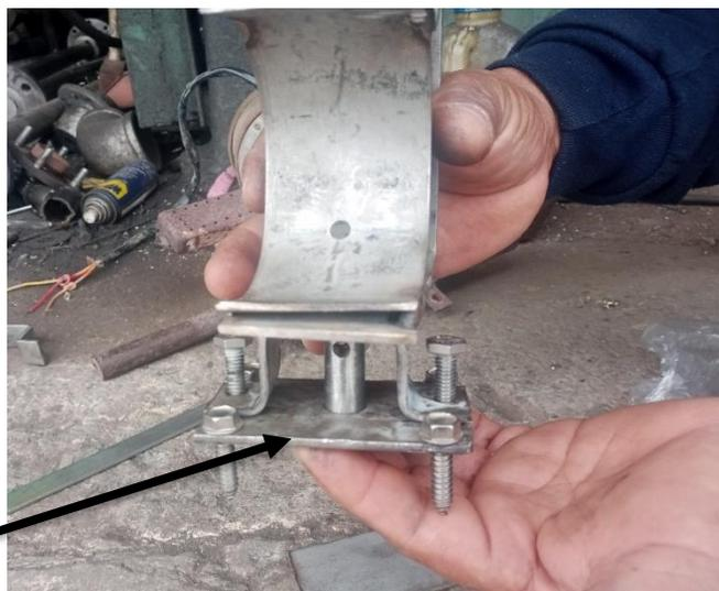
La platina de acero que va ir colocada en las embarcaciones es una nueva adaptación de soporte para nuestro sistema NISURI.
