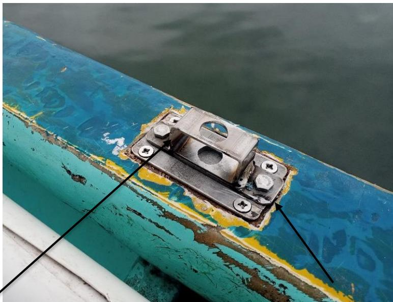
**Pernos de acero** de 2 pulgadas, sostienen la platina base en la borda de la embarcación
