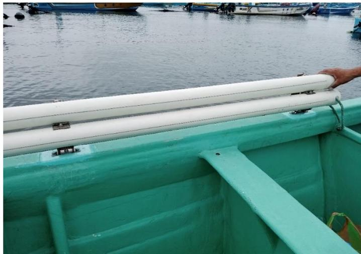
**Platinas terminadas y listas para ser colocadas en las embarcaciones**
