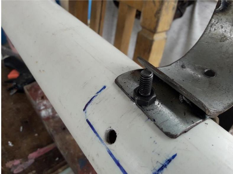
**Los sujetadores:** llevan pernos que mantendrán firme los tubos durante la faena de pesca, los sujetadores con pernos, nos permiten llevar los tubos cebados desde puerto hasta la zona de pesca., impiden que el oleaje afecte el sistema colocado en la borda de la embarcación. Evita que se salga de su posición.
