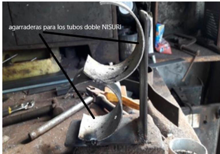
**Fabricación de agarres:** las agarraderas o sujetadores de tubo galvanizado para DOBLE NISURI, Según las especificaciones debían calzar perfectamente en los tubos que posteriormente serán colocados o sobrepuestos uno de otro. (ver foto)
