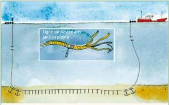
Figure 1. Configuration de la palangre automatique (Autoline).
