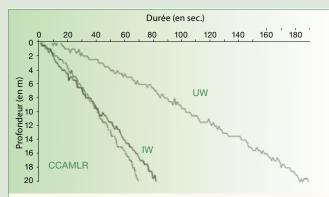
Figure 2. Profils des vitesses d'immersion pour les lignes autolestées (IW) et les lignes non lestées (UW), adaptation de Robertson et al. (2006).
