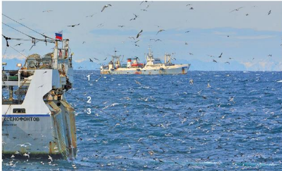
Рис. 1. Внешний вид крупнотоннажного траулера типа БМРТ и расположение кабеля прибора контроля трала – сетного зонда (1), правого ваера (2) и левого ваера (3) на стадии траления
